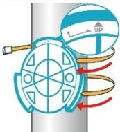
Führen Sie die Kabelbinder durch die Schlitzle auf der Bodenplatte. Legen Sie die Kabelbinder mit der texturierten Seite am Mast an, um Rutschen zu vermeiden. Ziehen Sie dann die Kabelbinder fest um den Mast, um die Bodenplatte zu fixieren.
